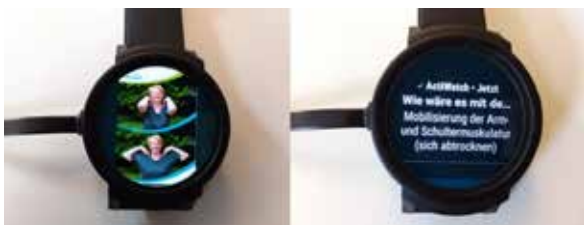
Abbildung 1: Die Geräte zur Benachrichtigung können auf mobilen Endgeräten (z. B. Smartwatch) Bewegungsübungen anzeigen und an die Durchführung durch visuelle und akustische Signale erinnern.
