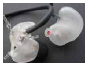
Abbildung 2: Prototypisches Hörsystem mit mehreren Miniaturmikrofonen und -lautsprechern, aus [Denk et al., 2019], siehe Publikationen
