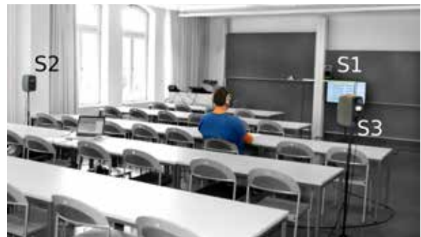
Hörversuch zur Beurteilung der Realitätsnähe kopfhörer-basierter Auralisierungen.
