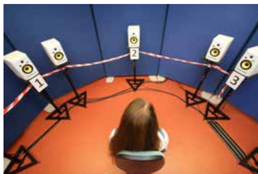
Abbildung 2: Probandin im Messaufbau für die Dual-Task Untersuchungen, aus den drei nummerierten Lautsprechern werden die Sätze dargeboten, der Lautsprecherkreis umfasst insgesamt 10 Lautsprecher (zum Teil außerhalb des Bildausschnitts), mit denen eine realistische Cafeteria-Situation simuliert wird.
